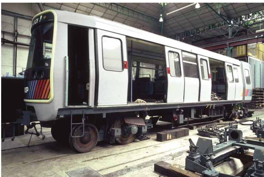
Neuentwicklung der 1980er-Jahre: Der „Train Boa“, hier am 26. Mai 1987 in den Ateliers von Vaugirard, war mit einer Art „Maximum-Fahrgestell“ am Wagenkopf ein ungewöhnliches Konstrukt
