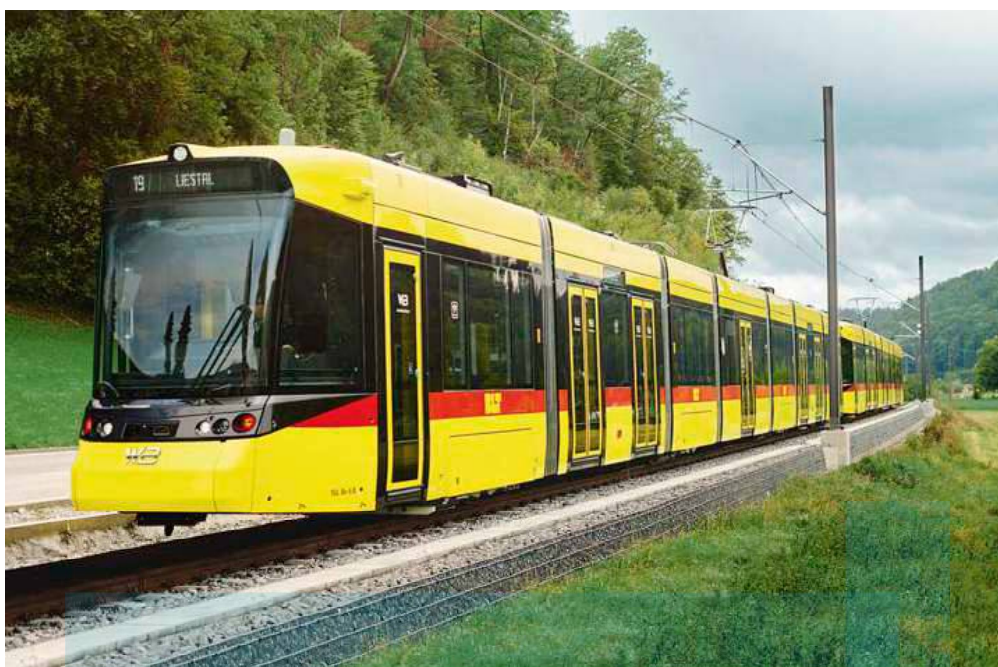
Eine Stadler-Tramlink-Doppeltraktion auf der Waldenburgerbahn. Auch hier sind die Sensoren im schwarzen Bereich der Front platziert
