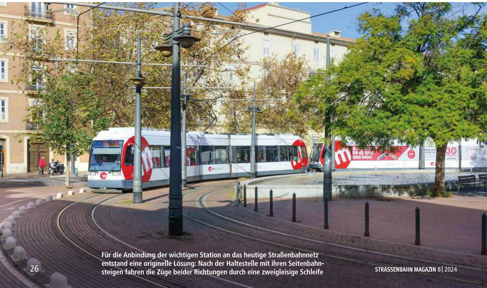
Für die Anbindung der wichtigen Station an das heutige Straßenbahnnetz entstand eine originelle Lösung: Nach der Haltestelle mit ihren Seitenbahnsteigen fahren die Züge beider Richtungen durch eine zweigleisige Schleife
