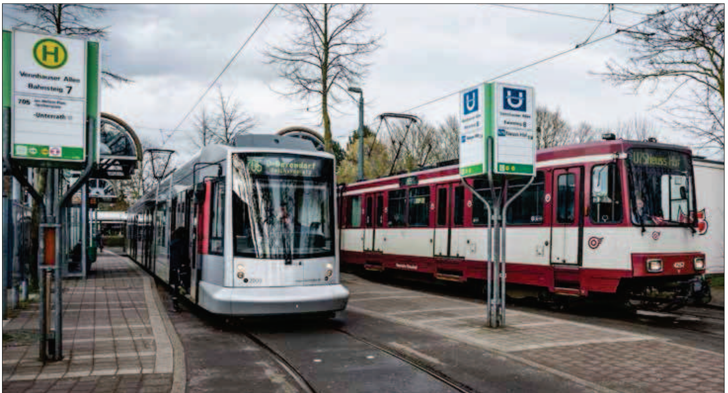
Schwer zu vereinbaren: Niederflur-Straßenbahn und Stadtbahn auf derselben Strecke.
