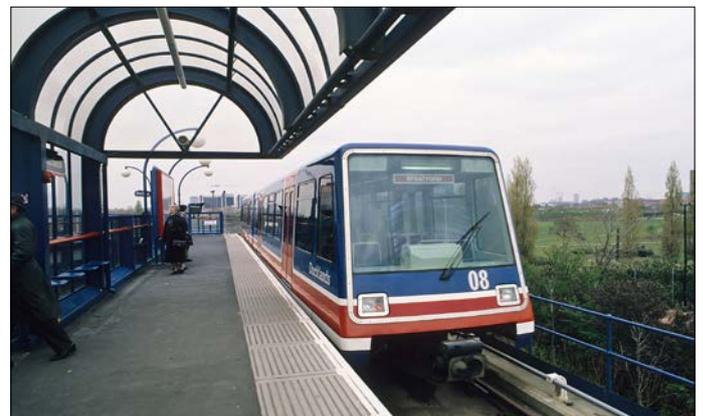
Das Bild zeigt einen Zug der ersten Generation, wegen nach britischen Vorschriften ungenügend brandhemmender Konstruktion konnte diese Fahrzeuge nicht auf der später gebauten Tunnelstrecke nach Bank eingesetzt werden und wurden daher nach Essen verkauft. © Foto: Harald A. Jahn
